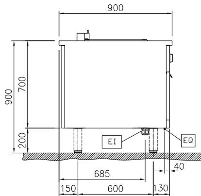
EI = Conexión eléctrica (energía)
